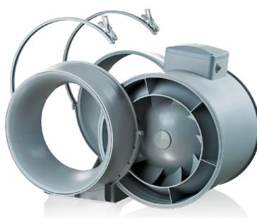
sind aus hochwertigen und langlebigen Materialien hergestellt. Das Gehäuse der VENTS TT-Serie wird aus ABS-Kunststoff, das Gehäuse von VENTS TT PRO-Serie wird aus schwerentflammbarem Polypropylen hergestellt. Die Zentraleinheit, bestehend aus Motor, Laufrad und Klemmkasten, wird an die Ventilatorstutzen mit Schlauchschellen befestigt.
